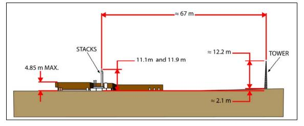
FIGURE 8: PROPOSED LOCATION OF WEATHER STATION TOWER VS LOCATION OF STACKS
